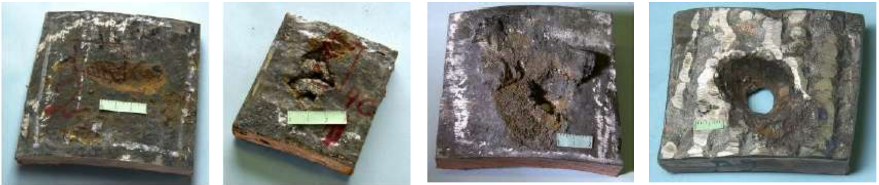
Bild5: Blasformschäden infolge Aufschmelzen: verschiedene Stadien
