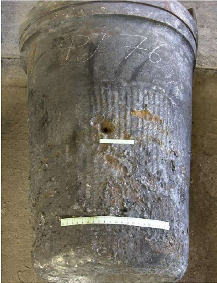
Bild2: Blasform PJ76 mit Vorderkam- merschaden nach dem Einsatz
